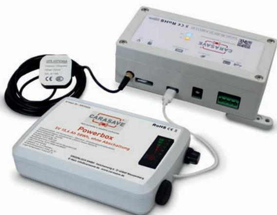
**⚠ Bitte beachten Sie den maximal zulässigen Strom von 200 mA am Hupen Ausgang. Für größere Lasten (z.B. große Hupe) nutzen Sie bitte unseren Leistungsschalter.**
